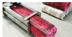
> La tecnologia di fusione superficiale risolve perfettamente il problema di compressione a vite, fondendo la superficie, le polietilene compattate all'interno non avrebbero espandere di
