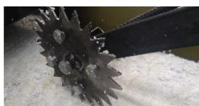
> Dispositivo che controlla la velocità per evitare fusione di polistirolo.
